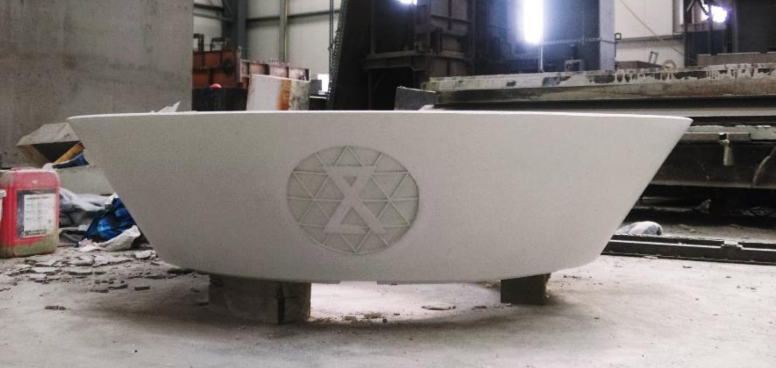
PREFABRYKATY Z BIAŁEGO BETONU MUREK Z TŁOCZONYM LOGIEM OSIEDLA W WARSZAWIE – DONICA Z TŁOCZONYM LOGIEM KOMPLEKSU BIUROWCÓW ALCHEMIA W TRÓJMIĘSCIE
